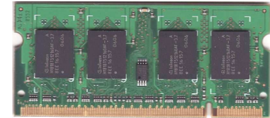
Infineon HYS64T64020HDL-3.7-A 512MB RAM
