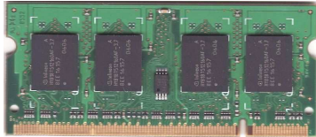
Infineon HYS64T64020HDL-3.7-A 512MB RAM
